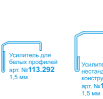
Створка 80 мм Softline XXL арт. №103.303* усилитель арт. №113.292 усилитель арт. №113.294 усилитель арт. №113.295
